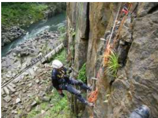
岩壁 1：一般国道落石源調査
