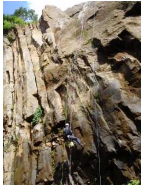
岩壁 2・3：柱状節理の発達した岩壁での物理探査支援業務
